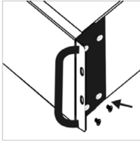
شکل ۲: نحوه‌ی اتصال قطعات L به بدنه دستگاه
